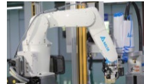
基板生産ラインに垂直多関節ロボットとマシンビジョンシステムを導入 (中国)
